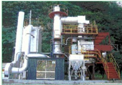
小型焼却炉「チリメーサー」を土台に開発された中型焼却炉「TG-195」。「設計は私、電子制御機器製造を株大成電気製作所、機械製造を琉球球動力が行いました。プロフェッショナルの技術を結集した設備です」と福富さん。1時間当たり約200kgもの廃棄物を処理できる。廃油なども燃料に使用でき、環境にも優しい。平成18年に産業まつり県知事最優秀賞を受賞し、さらに2006年には地球温暖化防止活動環境大臣賞を受賞した。
